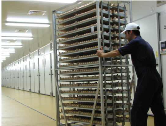
Ebene Böden und einwandfrei instand gehaltene Wagen sind unerlässlich, um die Rissbildung während des Eitransfers zu reduzieren
